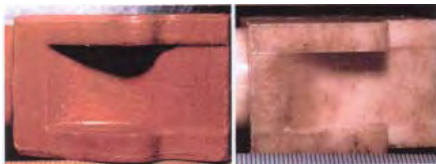
(図2) a - 従来の焼流し精密鋳型 b - 寸法形態精度の高い焼流し精密鋳型
