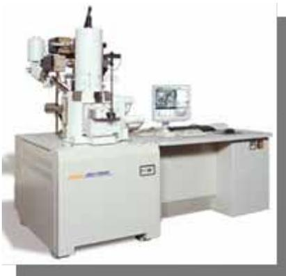
走査型電子顕微鏡 JSM-
