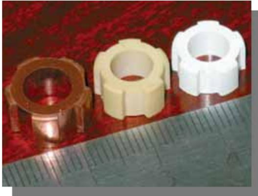
超音波を利用してプレスされる粉末内の摩擦力を調整し、内部応力の勾配が最小となるように、乾燥粉末を均一の密度で複雑な形状の製品に成型する
