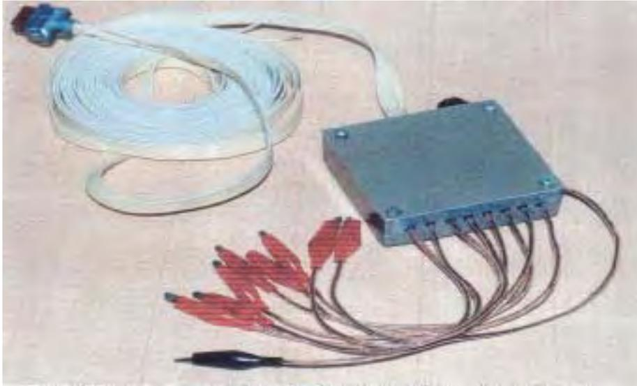
主な仕様 電流遮断機能を備え、小型である。絶縁電圧は1,000V以上。
