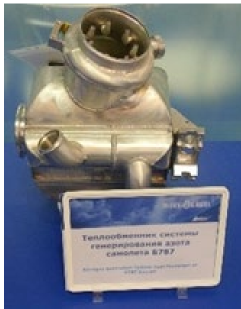
ボーイング 787 で使用したロシア製熱交換機
