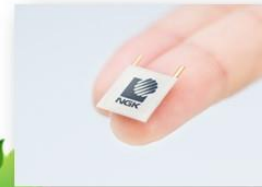
チップ型セラミックス二次電池
